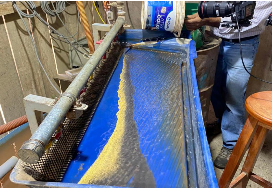
Shaking table production
